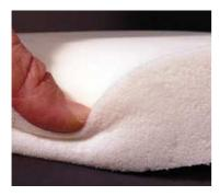
I prodotti realizzati in poliuretano flessibile sono ottenuti per iniezione in stampi di alluminio o resina termoregolati.
